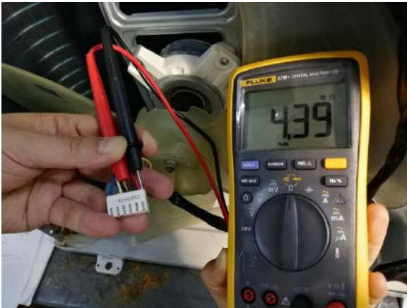
DC fan motor test point:
